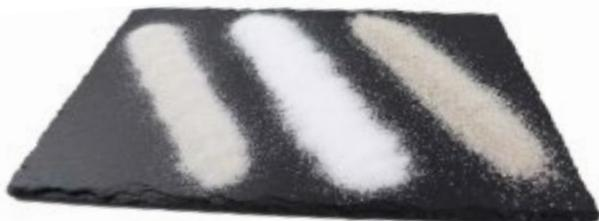
Durch das Einarbeiten von Quarzsanden oder Rutschhemmgranulaten erhält man eine raue, strukturierte Oberfläche und erzielt dadurch eine Rutschhemmung. Sie werden in die **noch frische Beschichtung eingestreut**. Damit die Oberfläche langlebig und widerstandsfähig bleibt, ist eine abschließende Versiegelung unerlässlich. Diese schützt den Rutschhemmer vor Abnutzung, Chemikalien und mechanischer Belastung.
