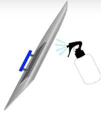
Immer wenn die Kiesel oder der Coloritquarz an der Glättkelle kleben bleiben, benetzen Sie diese mit dem Smoothing Agent E für einen sauberen Auftrag. Sprühen Sie nicht auf die zu beschichtende Fläche.
