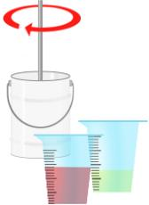
Rühren Sie bei der Entnahme von Teilmengen die Harzkomponente gut auf und wiegen Sie Harz und Härter in zwei separaten Mischgefäßen ab.
