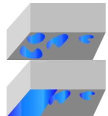
Mischung grob auf der Fläche verteilen und anschließend mit entsprechenden Werkzeugen verteilen.
