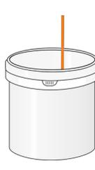
Mit dem Bohrmaschinen Rührer 120 so lange rühren, bis Kiesel / Quarz gleichmäßig benetzt sind (Körner sehen nass aus). Besonders **Rand- und Bodenbereiche** beachten!
