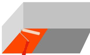
Beschichten Sie die Oberfläche satt und gleichmäßig, im Kreuzgang mit der Schaumwalze aus der Farbwanne heraus.
